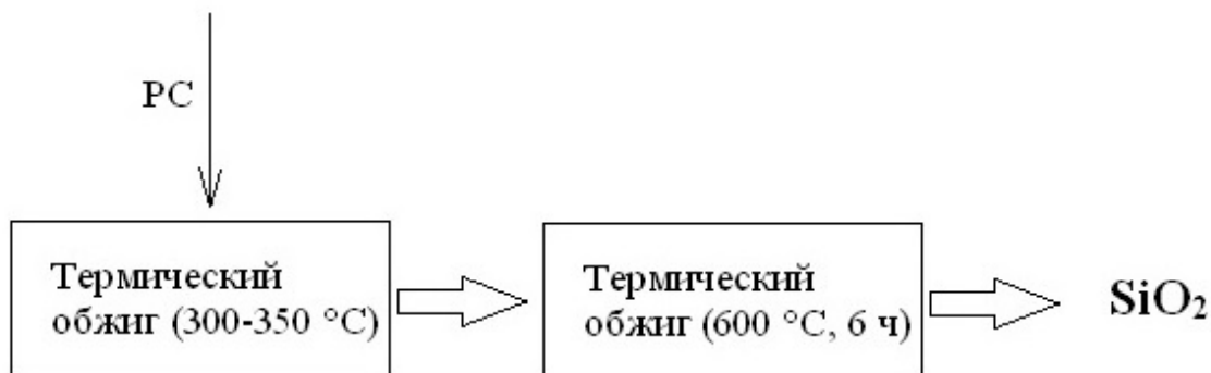
Рис. 1. Схема получения образцов аморфного диоксида кремния из рисовой соломы термическим обжигом (схема 1)
